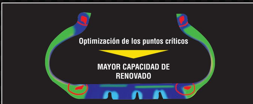
Estructura robusta y reforzada en los puntos donde la carga demanda un mayor esfuerzo.
