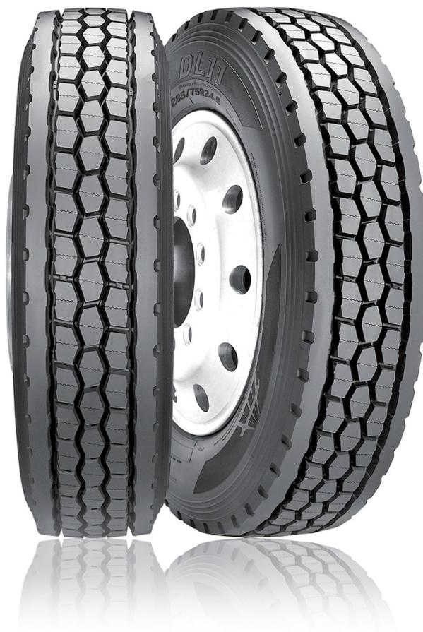
El nuevo desarrollo de Hankook Tire para larga distancia y del eje de tracción, DL11 esta diseñada para otorgar una alta eficiencia de combustible y un incomparable desempeño durante la conducción. Su nuevo compuesto de hule, garantiza una mejor y alta eficiencia de combustible, debido a su baja emisión de calor. Los sólidos bloques de los hombros y del centro con 3 canales, ayudan a recibir un mayor kilometraje y sobre todo, una excelente tracción.
